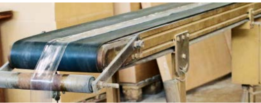
Endlos-Herstellung der nahtlosen Polyurethan-Folie
