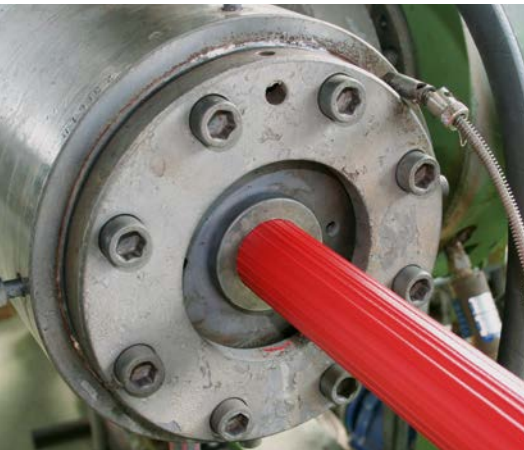
Gummierung wird im Extruder durch das Textilgewebe durchgedrückt
