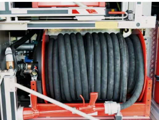
Schnellangriffsschlauch auf Haspel im Feuerwehrfahrzeug
