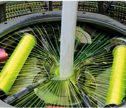
Im Webstuhl wird der Manchon mit textilem Gewebe umspannt
