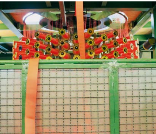
Webstuhl ausgerüstet für die Herstellung des leuchtorange Feuerlöschschlauches
