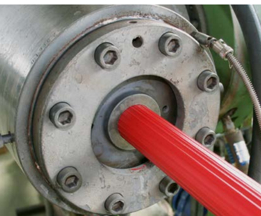
Gummierung wird im Extruder durch das Textilgewebe durchgedrückt
