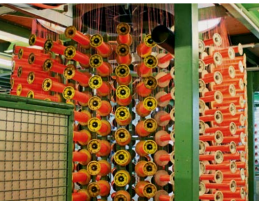
Über die Vielzahl von Konstruktionsvarianten kann man Faktoren wie u.a. Platzdruck und Abriebfestigkeit beeinflussen
