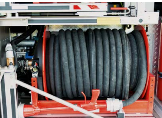
Schnellangriffsschlauch auf Haspel im Feuerwehrfahrzeug
