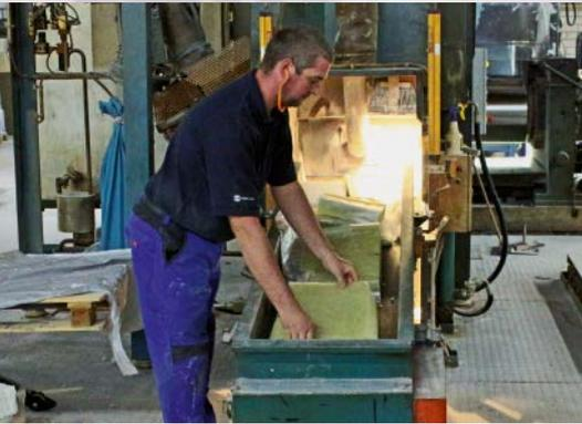
Ein Mitarbeiter legt die vorher abgewogenen Mischungsbestandteile auf das Förderband, welches die Bestandteile in den Innenmischer transportiert
