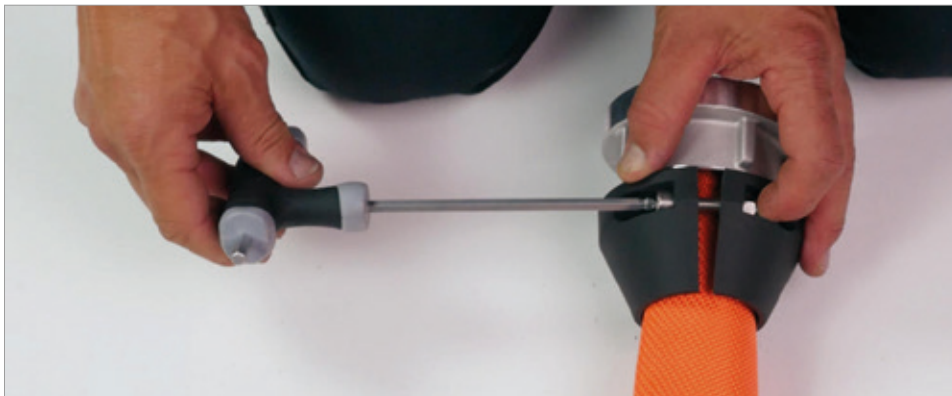
2. Schritt: Verschraubung an beiden Seiten mittels Inbus
