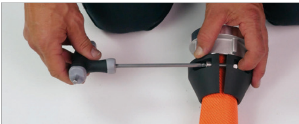
3. Schritt: Finales Festziehen beider Schrauben – Bereit für den sicheren Einsatz.
