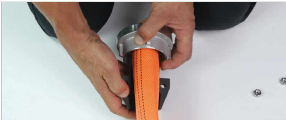
1. Schritt: Aufbringen der Klemmschale
