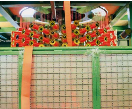
Webstuhl ausgerüstet für die Herstellung des leuchtorange Feuerlöschschlauches
