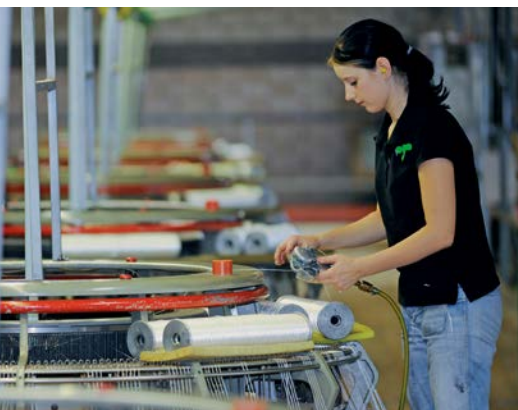
Spleiß- bzw. Einlegevorgang einer neuen Schusspule in den Webstuhl
